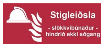
Mynd 1. Myndin af hjálminum og eldinum til vinstri er merki F004 samkvæmt ÍST EN ISO 7010 og kallast þar „To indicate the location of firefighting equipment“. Til hægri er merkið sýnt með texta fyrir stigleiðslu.
